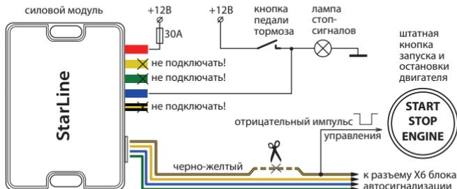
**Подключение входа контроля работы двигателя**
