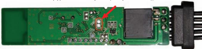
2. на 10 секунд подайте питание на реле. После отключения питания разомкните контактные площадки. Теперь реле снова можно записать в память автосигнализации.
