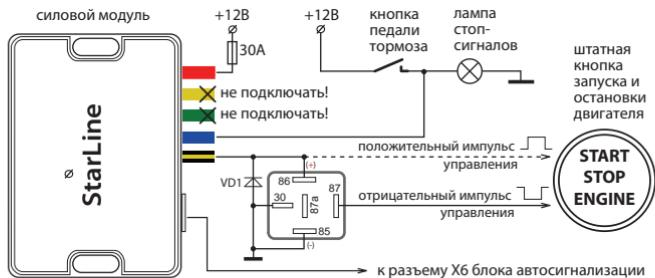
**Схема 2: слаботочное управление кнопкой «старт-стоп»**
