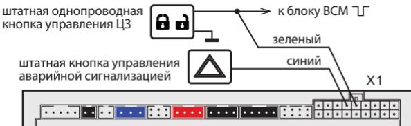
Выходы альтернативного управления активируются автоматически (после записи в память автосигнализации номера, соответствующего Вашему автомобилю). Активный управляющий уровень - отрицательный. Предельно допустимый ток нагрузки на выходе - 200 мА. Информацию о возможности альтернативного управления и способах подключения Вы можете найти на странице [can.starline.ru](http://can.starline.ru)
