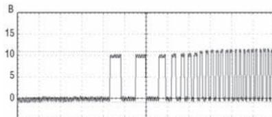
Момент прекращения прокручивания стартера автосигнализация определяет по резкому возрастанию частоты сигнала в момент начала работы двигателя. Подключение серо-черного провода к такой цепи гарантирует правильное отключение стартера.
