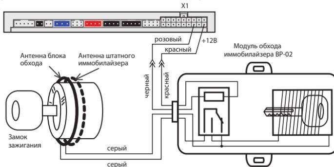
Если требуется подключить модуль обхода в разрыв антенны штатного иммобилайзера, следует использовать схему включения приведенную ниже:
