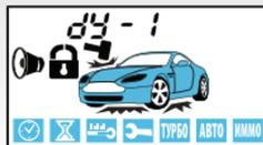
• сработал датчик наклона
