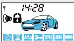
• Если брелок находится в зоне уверенного приема сигналов центрального блока автосигнализации, на дисплее постоянно отображается иконка ▼.
