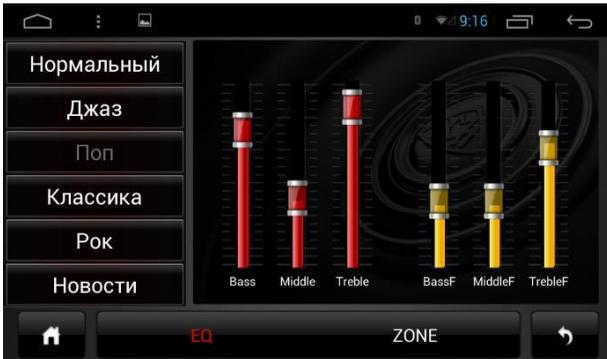
**Bass, Middle, Treble** – регулировка усиления полосы низких, средних и высоких частот.
